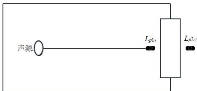
图 4-4 室内声源等效为室外声源图例
