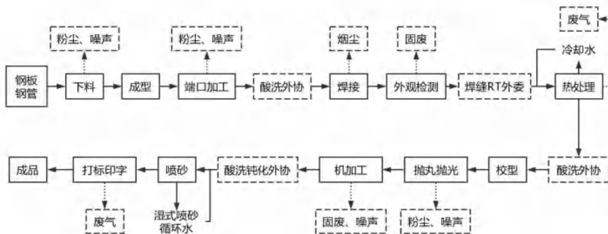
图 2-3 无缝管件生产工艺流程及产污环节示意图
