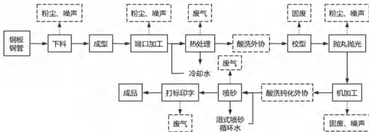
图 2-4 有缝管件生产工艺流程及产污环节示意图
