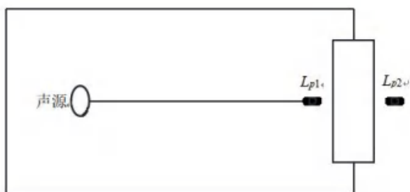
图 4-2 室内声源等效为室外声源图例
