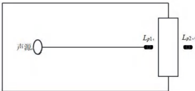
图 4-3 室内声源等效为室外声源图例
