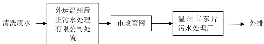
图 4-2 清洗废水处理工艺流程图
