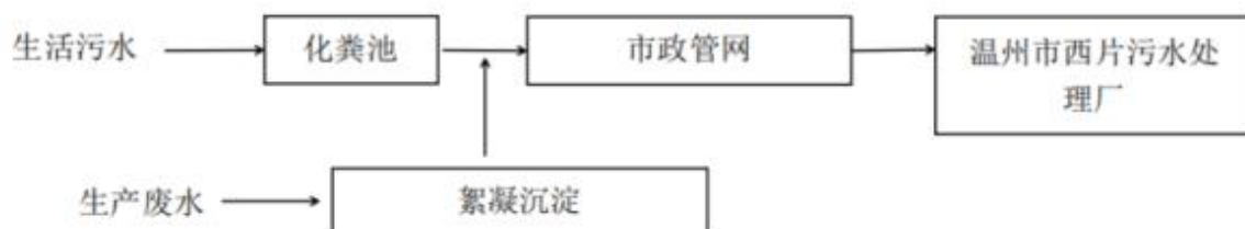
图 4-1 污水处理工艺流程图
