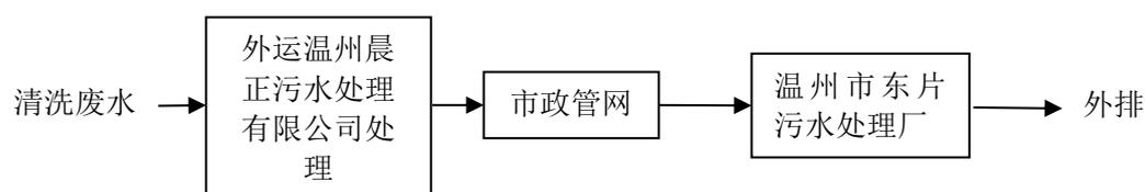
图 4-2 清洗废水处理工艺流程图
